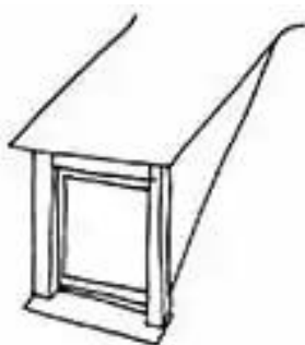
Lucarne rampante, ou en chien couché
