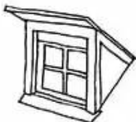
Lucarne retroussée, ou en chien-assis
